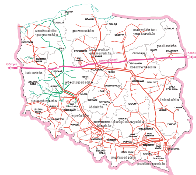
Rysunek 5.35. Aktualny stan krajowego systemu przesyłowego
